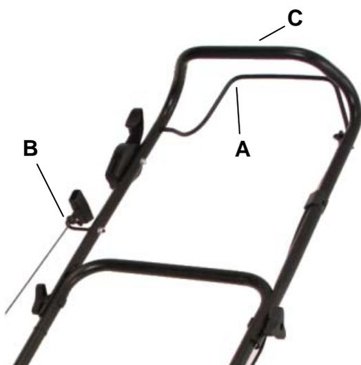
Dra handtaget (A) som lossar knivbromsen in mot styrhandtaget (C) och dra i startsnöret (B), så att startsnöret kan sättas fast i hållaren.
