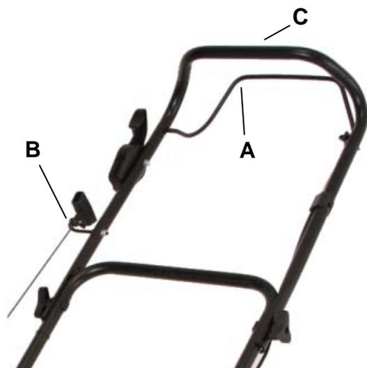
Træk håndtaget (A), der løsner knivbremsen ind til styrehåndtaget (C), og træk i startsnoren (B), så startsnoren kan fastgøres i holderen.
